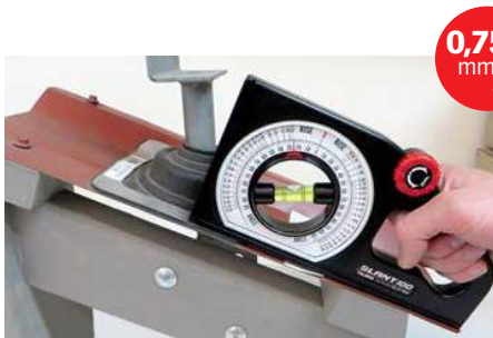
Hellingsmeter SLANT 100 • Mesureur d'angle SLANT 100
