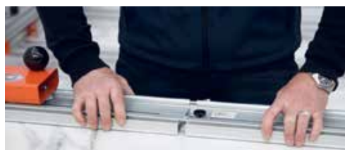
Koppelbare rails vergroten de snijlengte Rails raccordable augmentant la longueur de coupe
