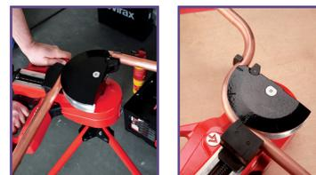
\* 251849 : forme Ø28mm pour tube inox Ø 28 x 1,2 mm - Rayon cintrage 112mm.
