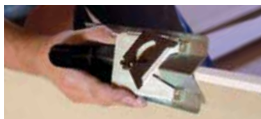
Afkantschaaf voor gipsplaten, met instelbare snijhoek "RAP-PLAC" Rabot à chanfreiner pour plaques de plâtre, à angle variable "RAP-PLAC"
