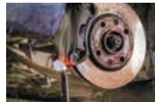
Débloage Disques de freins Inducteur S20/B1
