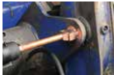
Redressage Maintenance agricole Inducteur L180
