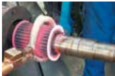
Débugage Engrenage Inducteur boucle L
