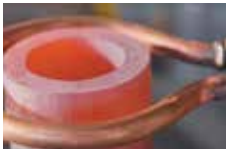
Dégrippage Boulon / vis / tuyau Inducteurs boucles S/L
