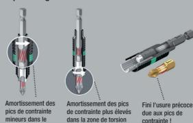
Les adaptateurs BiTorsion de Wera possèdent un ressort de torsion qui absorbe les pics de contrainte mineurs lors du vissage. Leur utilisation conjointe avec les embouts BiTorsion et leur zone de torsion prolongent sensiblement la durée de vie de l'outil.
