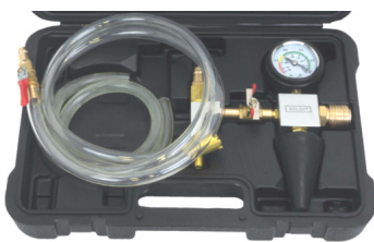
K2515 Vacuumvuller voor koelsysteem / Purger et remplir le système de refroidissement 67 €
