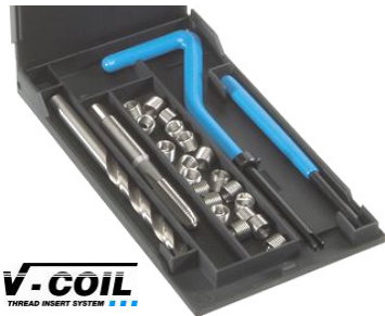
Schroefdraad reparatieset / Jeu de réparation de filets. Met/ Avec 20 inserts M2 à M8, 15 inserts M9 à M10 10 inserts M12 à M16, 5 inserts M18 à M24. Avec mèche / met boor de / van M2 à M12
