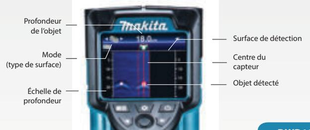
Le DWD181 utilise une technologie radar pour détecter avec précision le métal, le bois, le câblage électrique et d'autres objets dans les murs et les sols
