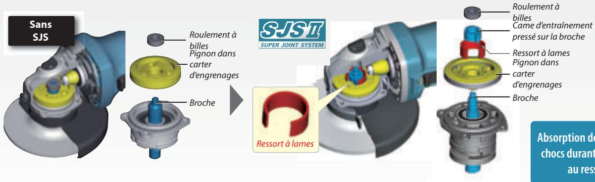
Absorption des vibrations et des chocs durant le meulage grâce au ressort à lames
