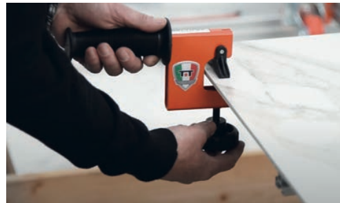
Easy Break voor tegels tot 25 mm dikte Easy Break pour les carreaux jusqu'à 25 mm d'épaisseur
