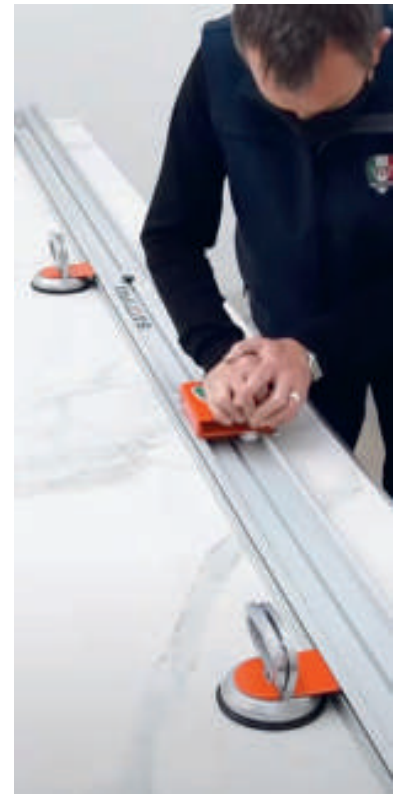
Slede met 3 nylon verschuifbare katrollen Chariot avec 3 poulies coulissantes en nylon
