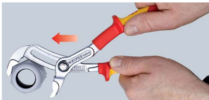
Réglage rapide à même la pièce sans avoir à appuyer sur le bouton
