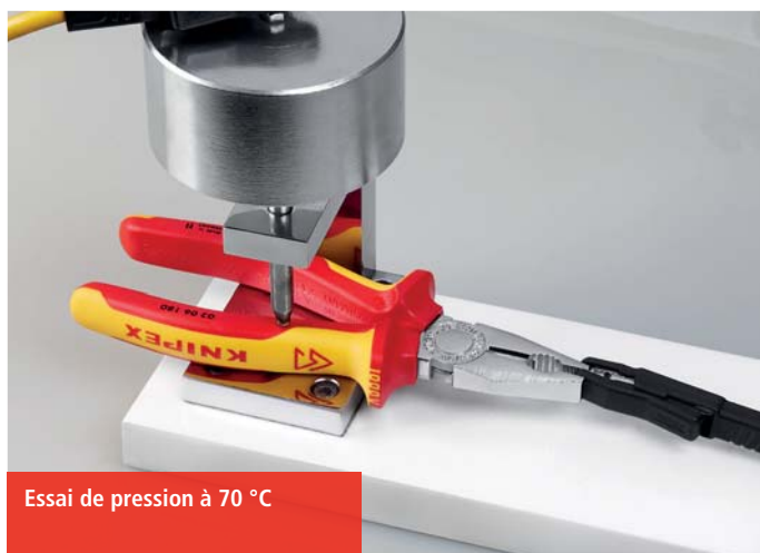
Contrôle de l'adhérence du revêtement isolant sous 500 N.
