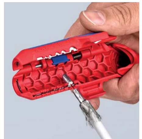
Dénudage d'un câble coaxial
