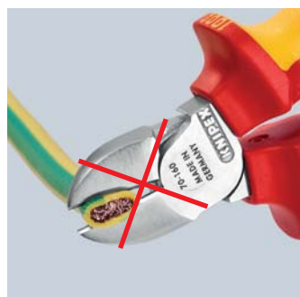
Coupe d'un câble avec une pince coupante de côté : effort physique plus important, coupe peu nette, déformation et écrasement importants du câble
