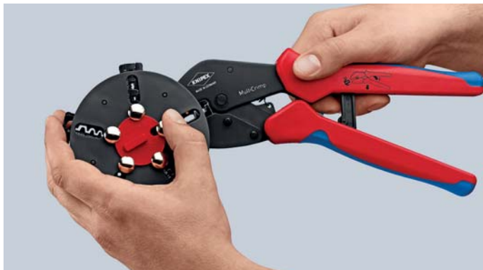
Changement du profil de sertissage : déverrouiller la position du magasin, extraire le profil de la pince
