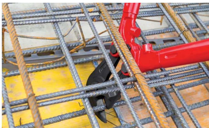
La forme spéciale de la tête du coupe-treillis 71 82 950 permet de couper des aciers de coupe-treillis à plat
