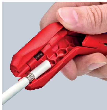
Dégainage d'un câble coaxial
