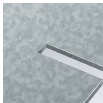
Découper et briser les copeaux en une seule opération
