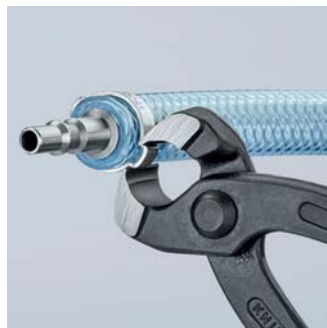
Étancher tuyau pneumatique au couplage rapide
