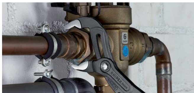
Les dentures orientées dans le sens inverse de la rotation entraînent un effet autobloquant et empêchent tout glissement sur la pièce.
