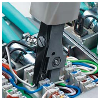
Pression et coupe en une seule opération
