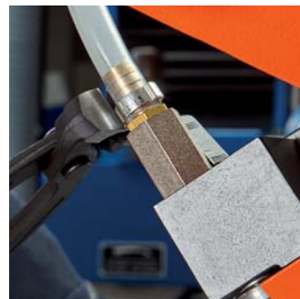
Étancher raccord de tuyau au graissage central
