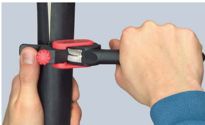
Tourner l'outil pour réaliser une coupe circulaire
