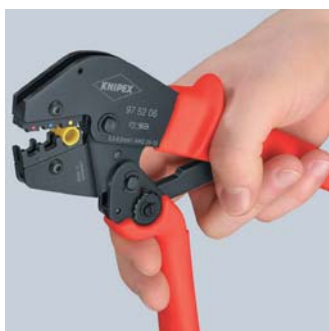
Première étape : rapprochez les deux poignées de deux doigts, jusqu'à ce que les deux mâchoires touchent le connecteur à sertir
